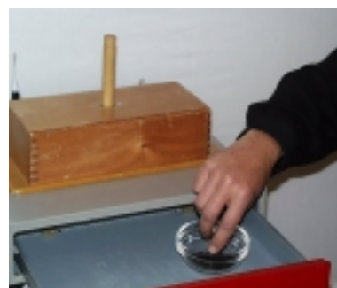
Illustrasjonen viser hvordan skuffen til et kassaapparat har blitt tilkoblet en bryter for å kunne benyttes i et spill.
