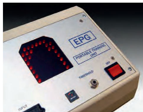
Måleinstrument som viser barnets artikulasjon
