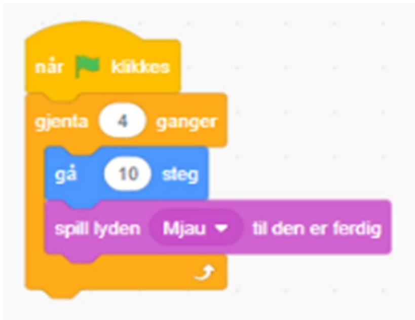
Figur 2: Kodeeksempel fra Scratch: gjenta 4 ganger: gå 10 steg og spill deretter lyd Mjau. e
